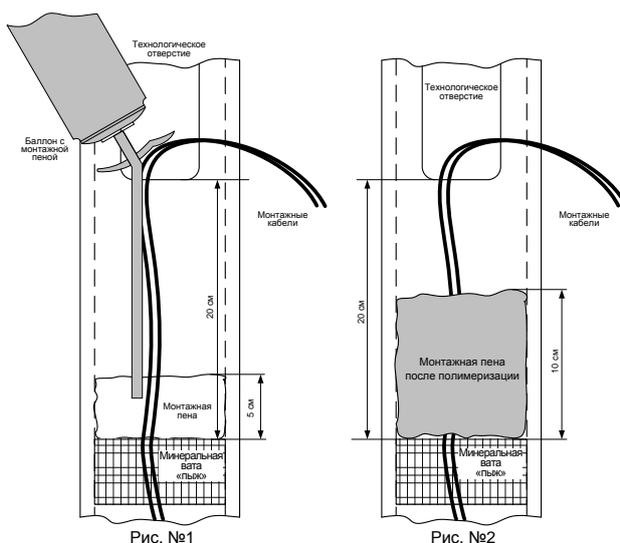
После полимеризации пены, обеспечивается герметизация внутреннего объёма изделия и защита от испарений влаги со стороны грунта.
